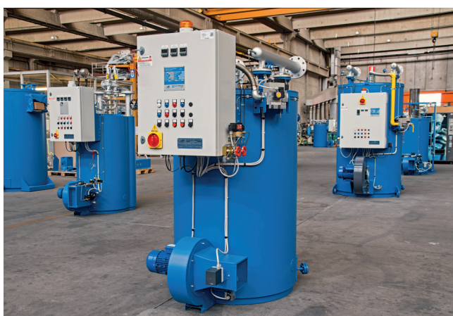
Chaudières TPC en Construction
